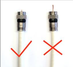
**HINWEIS:** Bitte achten Sie bei der Montage der F-Stecker darauf, das der Innenleiter des Koaxialkabels nicht zu weit aus dem Stecker herausragt. Es besteht sonst die Gefahr, Bauteile im Inneren des Geräts zu beschädigen.
